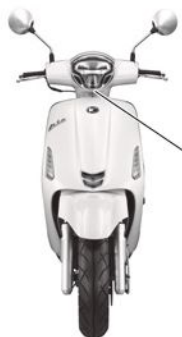
Vite di regolazione (sotto il faro)
